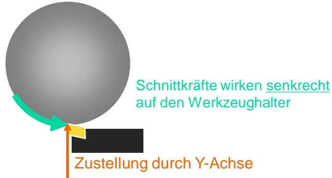
„Spezielle Werkzeuge, bei denen der Schnittkräfte nicht seitlich, sondern senkrecht auf den Halter wirken, erlauben wesentlich höheren Bearbeitungsvorschub“
